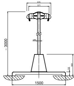
Uitvoering met betonvoet en Volant-Plus
