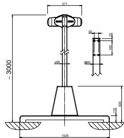
Uitvoering met betonvoet en afgeronde voorlijst
